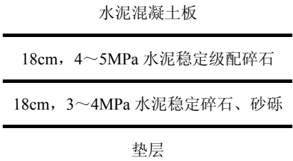
图 6-1 广东省水泥混凝土路面常用基层结构
